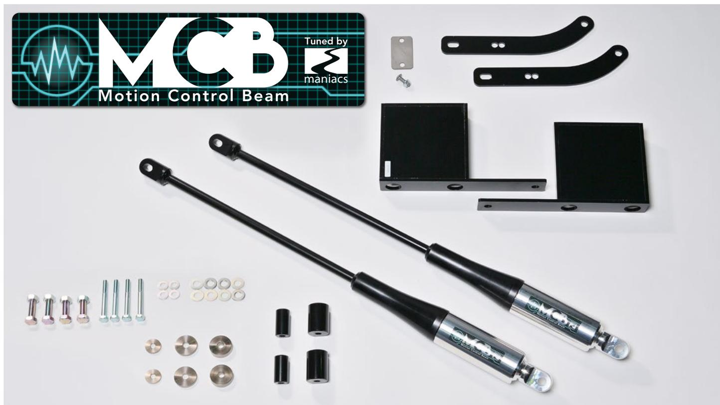
MCB Tuned by maniacsは、クルマ本来が持つ走りの性能を引き出し安定性と快適性を高め、“走りの楽しさを体感できる”機能部品です。主に、コーナリング（ステア操作時）のボディー横揺れ減少とトレース性の向上、突起乗り越し後の縦揺れの収束性向上を目指して設計された製品で、フォルクスワーゲン用に maniacs で開発を行いました。ボディー前後に装着することで、「ボディーの歪低減」「振動低減による、上質なステアリングフィールの実現」「乗心地の向上」に貢献し、高速走行での安定性、一般道での運転のしやすさなども体感できる製品となります。
